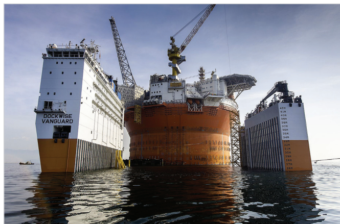
Kompletní nátěrový systém pomocných konstrukcí jednotlivých technologických zařízení ropné plošiny Goliat dosáhl 325 mikronů a byl proveden vysokotlakým zařízením.
