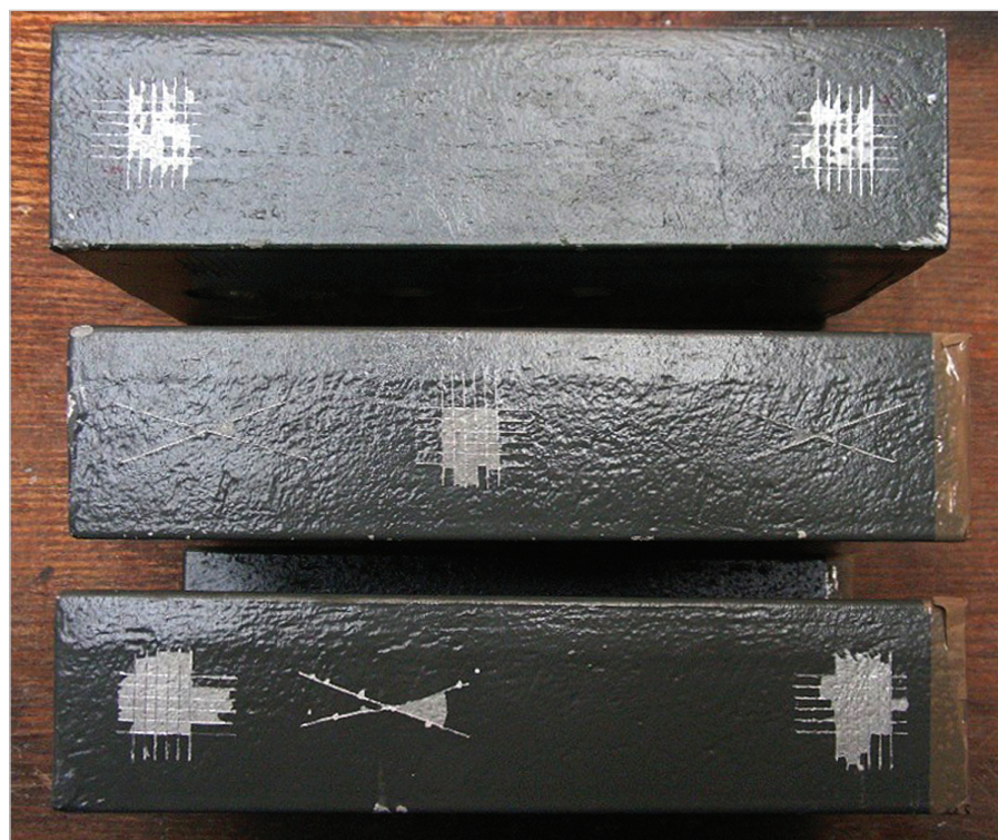
Mřížková zkouška na vzdálenost řezů 3 mm, lepicí páska 3M (Scotch) o šířce 50 mm, celková tloušťka duplexního NS: 278–430 \mu\text{m} , tloušťka Zn vrstvy 120–180 \mu\text{m} . (Foto: SVÚOM)
