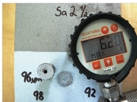
Obr. 5 a 6. Odtrhové zkoušky metalizace na povrchu tryskaném na Sa 2 1/2 a Sa 3
